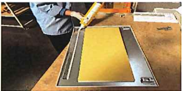
組付作業風景① 接着
